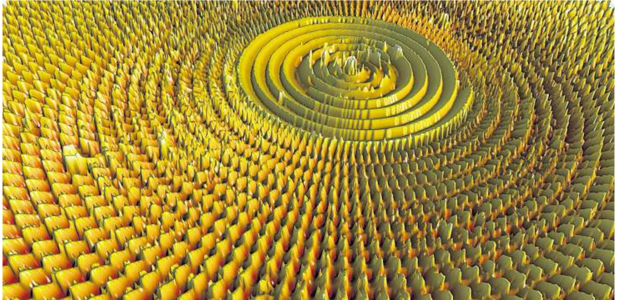
Diese feine Struktur ist im Labor für Mikrozerspanung entstanden. Die Erhebungen sind lediglich einige Dutzend Nanometer (milliardstel Meter) groß.
